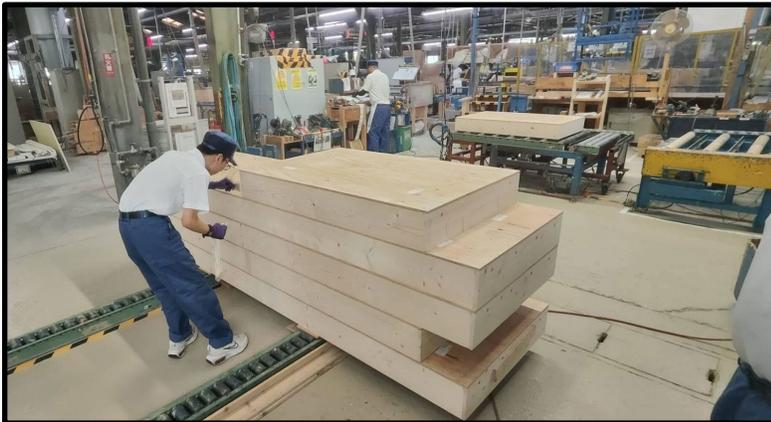
塗って埋めたり、出荷前に全て整っているかの確認などをしました。小型クレーンのようなものを操作して、下の写真に写っているようにパネルを積み上げたり、積み上げたものがずれないように固定するための木材を打ち付けたりもしました。これも割と単純で、すぐにコツを掴める作業でしたが、これらのパネルが実際に家に使われると知ると、少し接着剤を塗る仕事でもミスを犯せないと言うプレッシャーを感じました。
