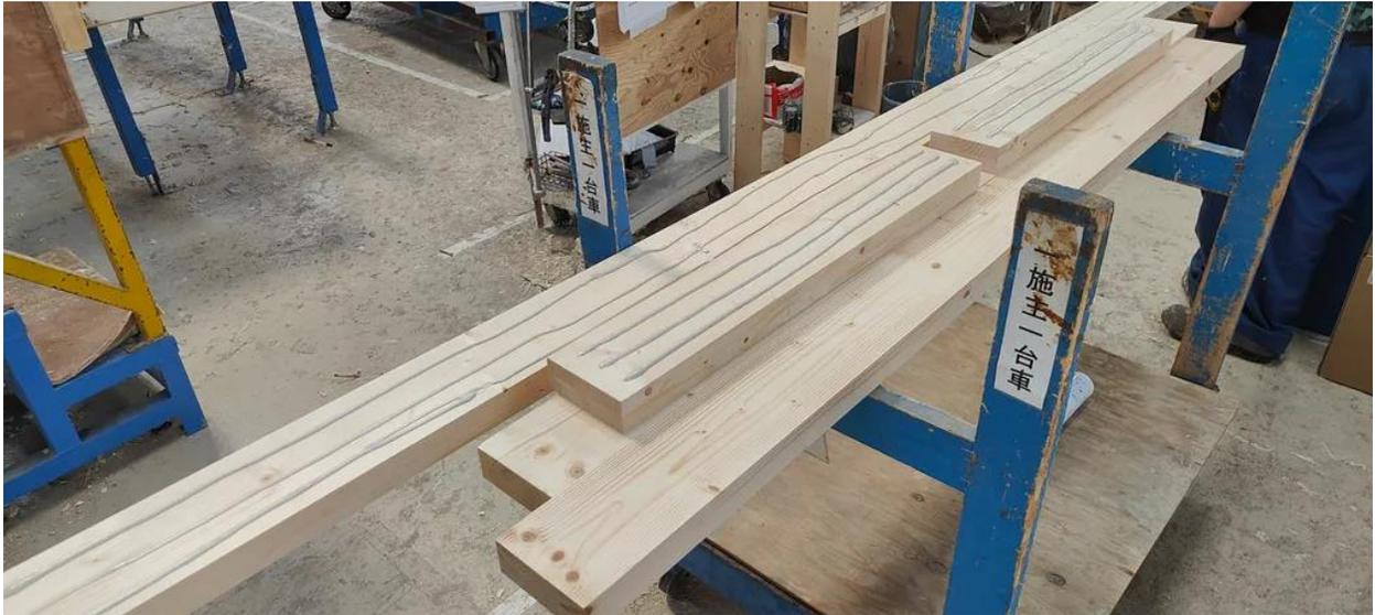
今日は伊志嶺課長、そしてエマさんと工場で現場体験しました。今回の現場体験はパネルの接着剤と木材の塗装作業でした。前回は僕は機械に木材を投入するばかりで、このステップもっと重要だと思います。木材のサイズによって、接着剤の用量が異なります。一回の用量の標準があるので、製品の要求が厳しい基準です。もし必要があれば、電動ドリルを使用してネジを取り付けて、パネルを固定します。終わったら、パネルに番号を付け、その後で、建築現場に運びます。したがって、このステップは出荷前に最後の検査ということです。とても大変でした。パネルを組み立て、間隙を検査して、最後の検査だから、製品の確認することが一番大切だと思います。
